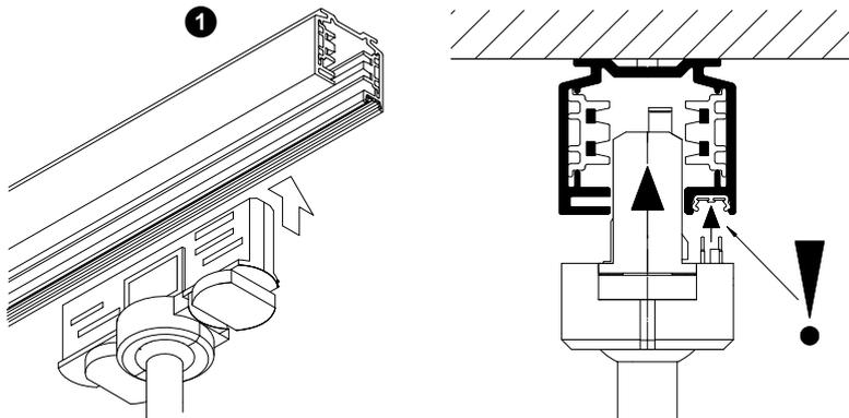
Für den Anschluss des Adapters an den Neutralleiter, Drehriegel **A** um  $90^\circ$  im Uhrzeigersinn drehen.
