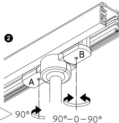
Für den Anschluss des Adapters an Phase 3 Drehriegel **B** herausziehen und um  $90^\circ$  gegen den Uhrzeigersinn drehen.
